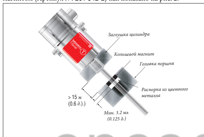
Рис. 2: Модель ТН, тип "Стержень", монтаж
